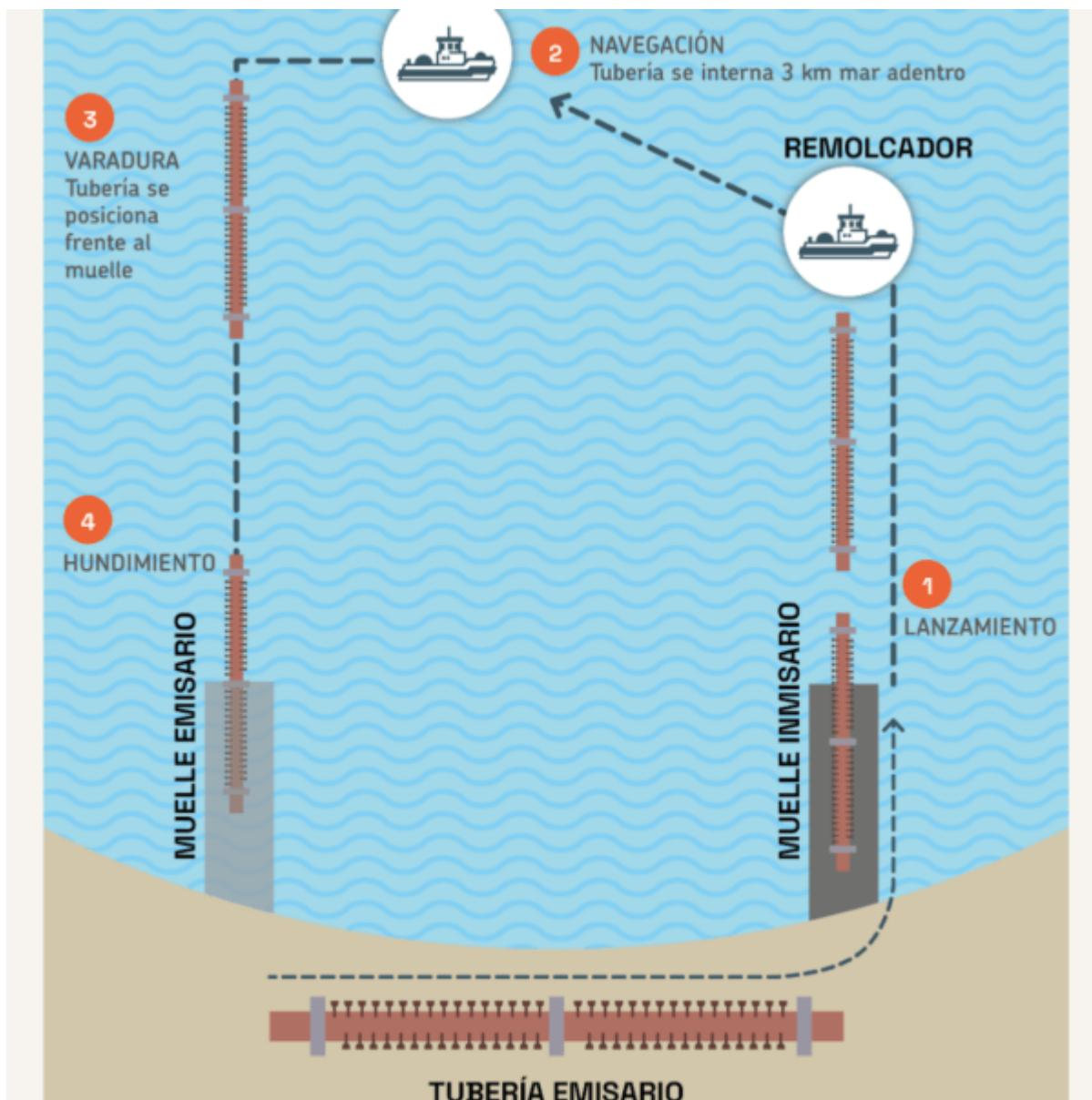
Exitoso lanzamiento y hundimiento del emisario de la planta desalinizadora de aguas pacífico en la bahía de Quintero - Puchuncaví
